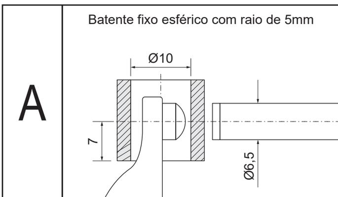
Esta configuração é ideal para medição de espessura de peças cilíndricas, como paredes de tubos por exemplo.
