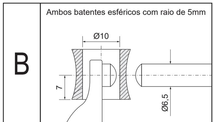
Esta configuração é ideal para medição de espessura ou parede de peças cilíndricas quando as superfícies interna e externa são curvas.
