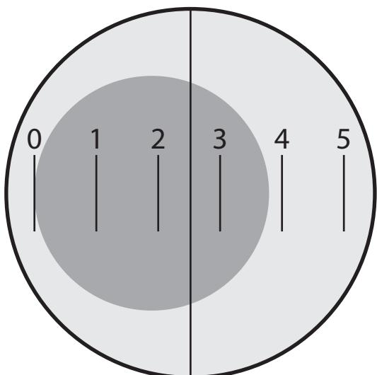
› Após a medição ser realizada, alinhamos a lateral esquerda da calota (impressão da penetração na peça) junto ao traço <ZERO> da escala na lupa.
