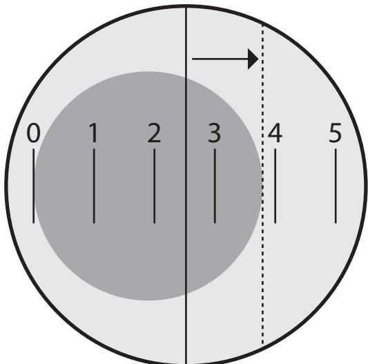
› Movimentamos então o tambor para o traço alinhar na lateral direita da calota. O valor dos centésimos será indicado no micrômetro de <0,00~0,99> mm.
