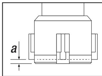
Distância "a" para medição em "furo cego" de 1,5mm (capacidades de 3,5~100mm) e de 17,5mm (demais).
