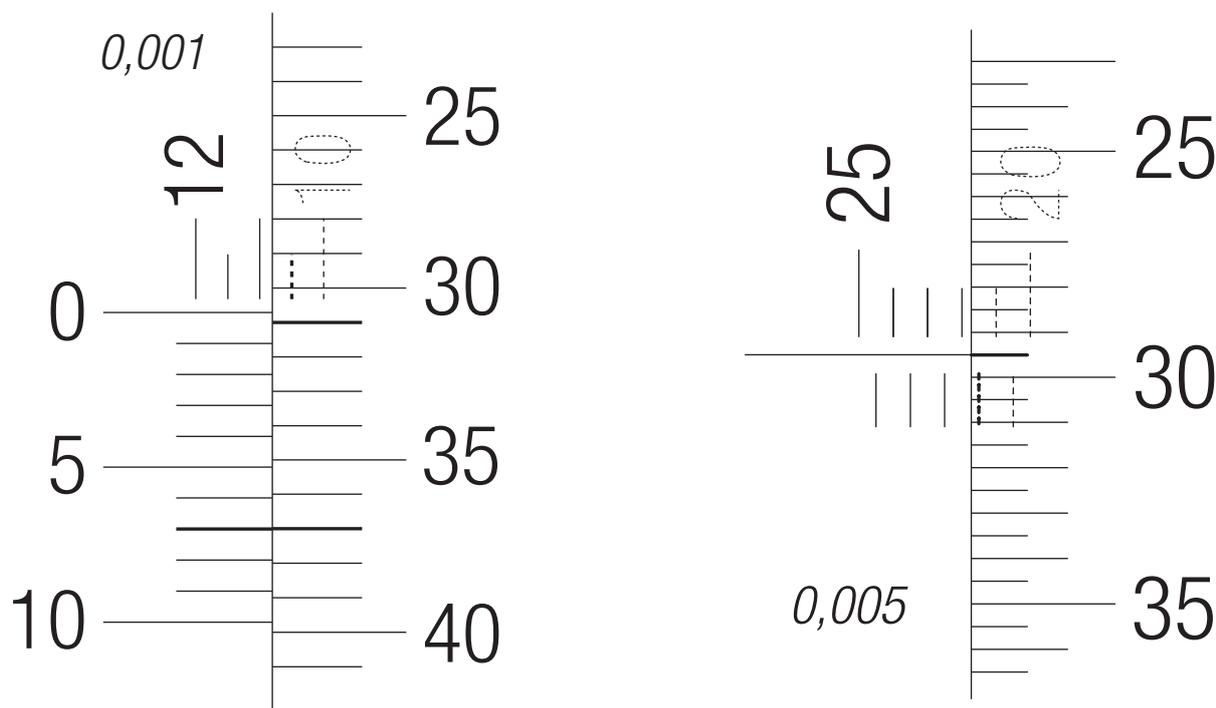
**Exemplo de medição (nos modelos com graduação de 0,001mm):**
