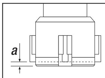
Distância "a" para medição em "furo cego" de 1,5 mm (capacidades de 6~12 mm) e de 0,5 mm (demais).
