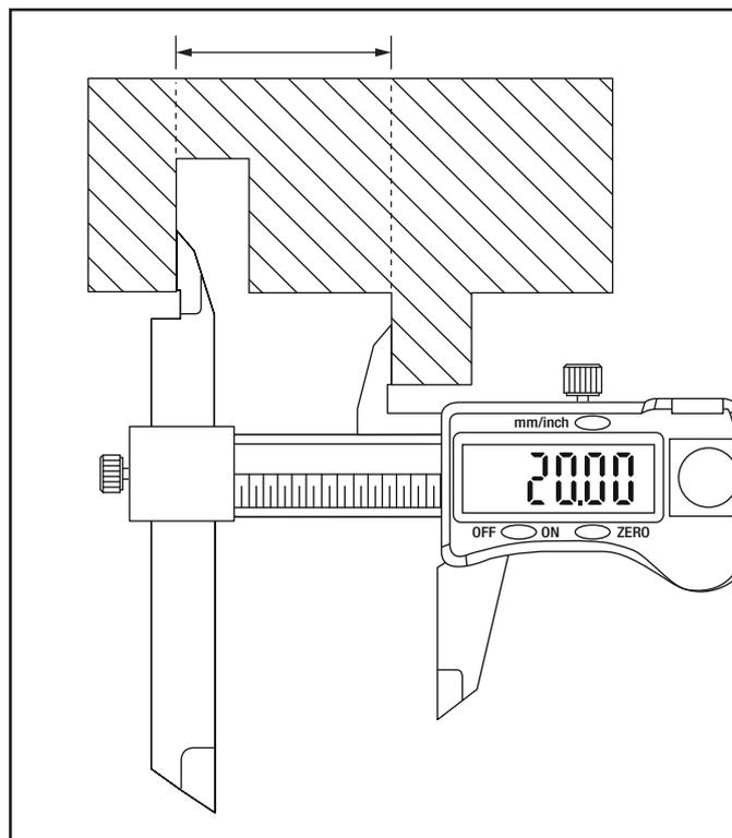
**Medição correta com o paquímetro com bico ajustável**
