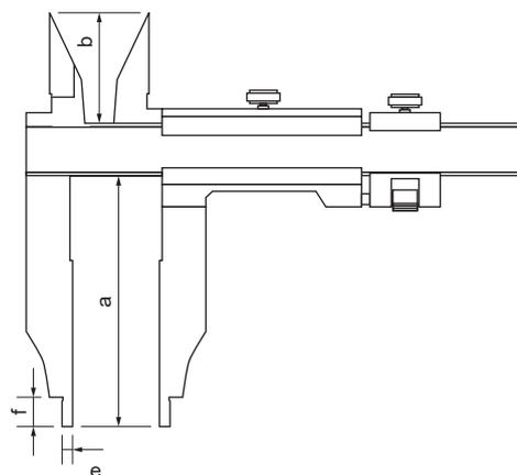
**Paquímetros para Serviços Pesados com Orelhas para Medições Internas**
